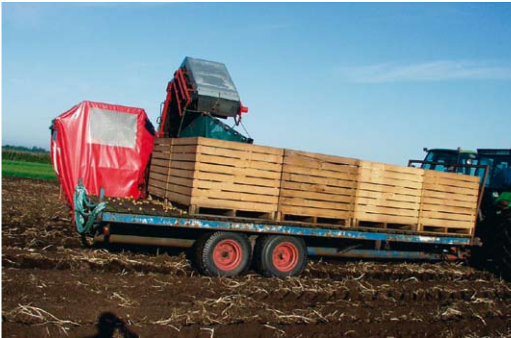
Figur 15. Optagning direkte i kasser på vogn ved siden af optageren.
