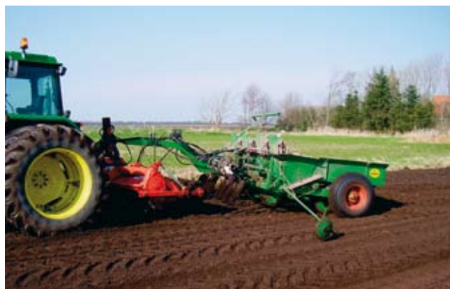
Figur 4. Kombinationsmaskine udstyret med nedfælder til flydende gødning.
