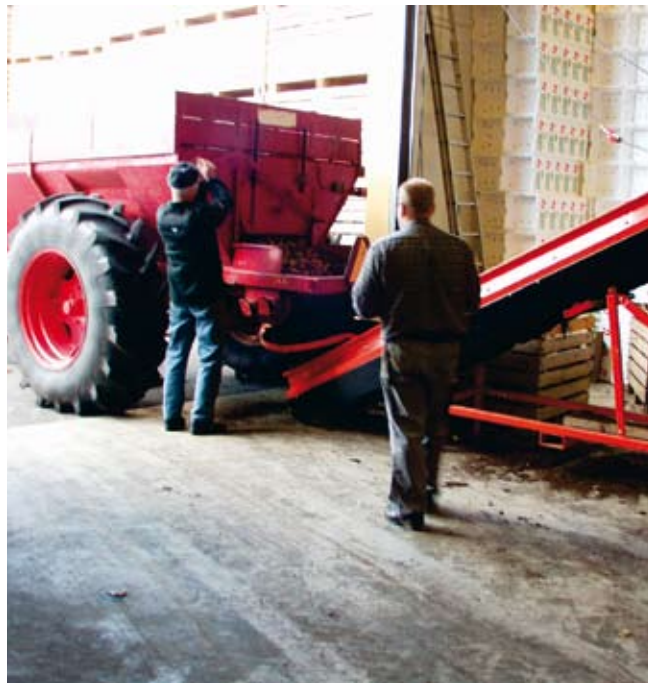
Figur 19. Aflæsning ved hjælp af transportbånd til afrensning og manuel sortering
