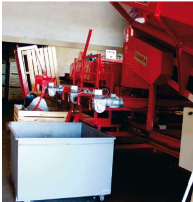
Figur 18. Stationært anlæg til sortering ved indlagring.
