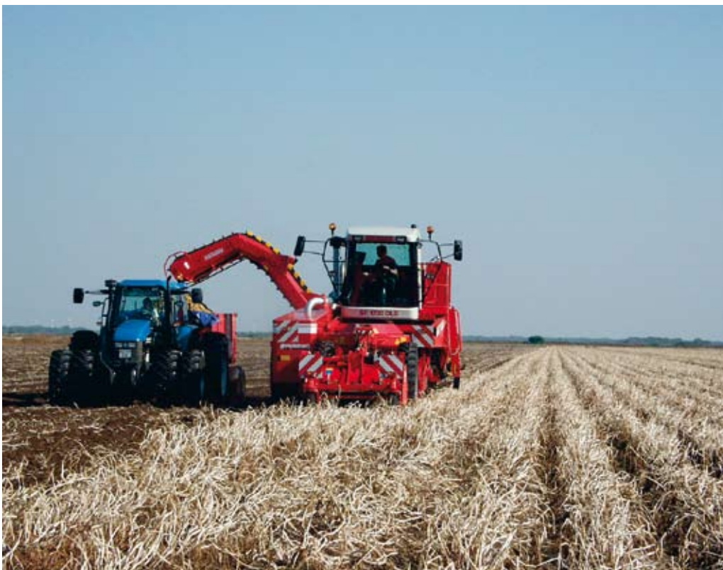
Figur 11. Selvkørende kartoffeloptager med svanehalselevator.
