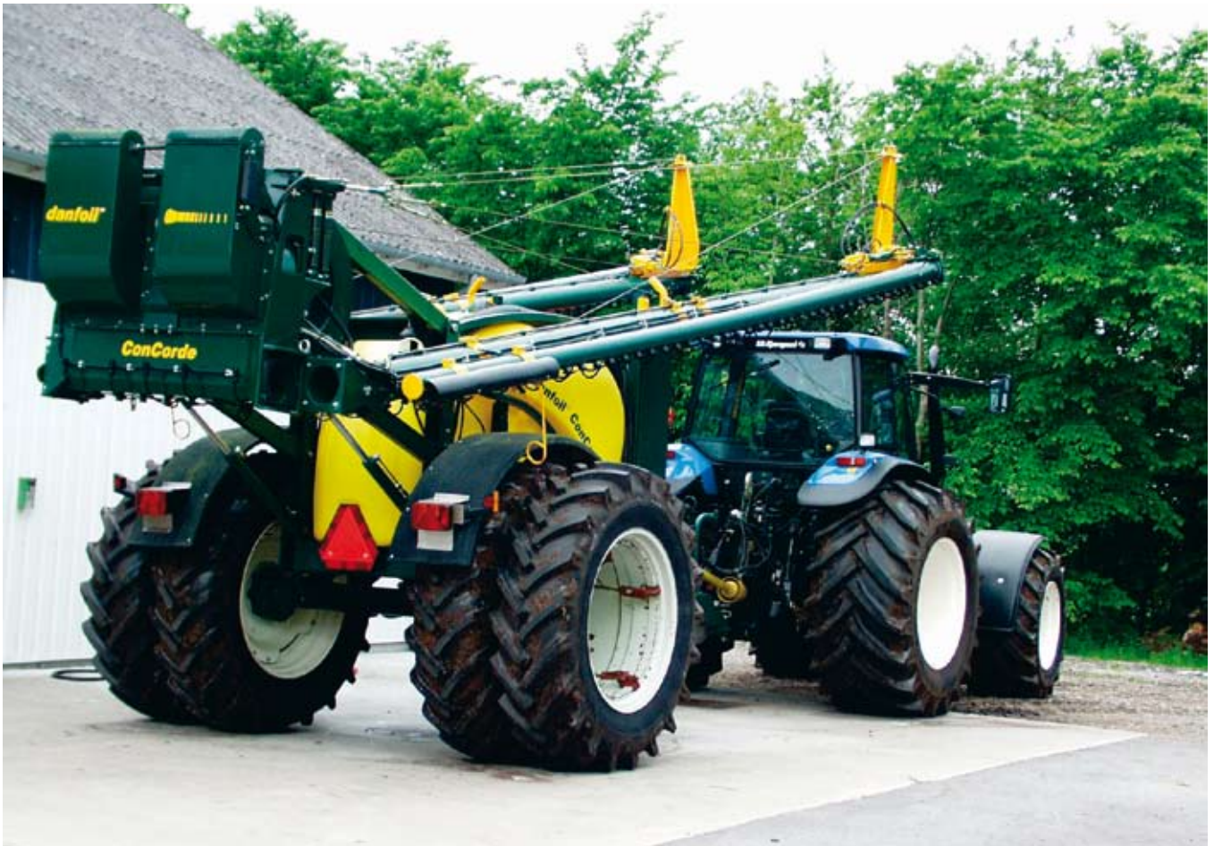
Figur 7. Sprøjte med påfyldningsudstyr, rengøringsudstyr og ren vandtank plus boks til værnemidler.
