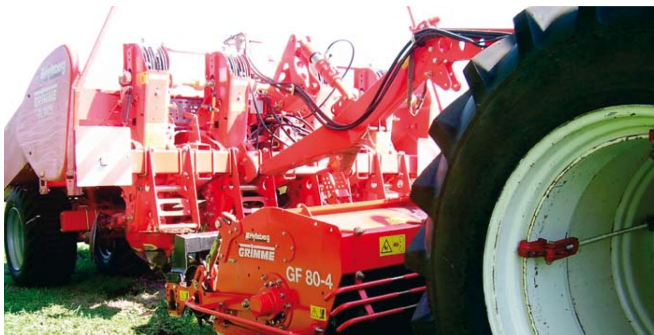
Figur 6. Kombinationsmaskine til tilberedning af bede og lægning af kartofler.
