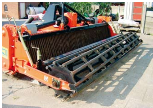
Figur 3. En stenedlægningsfræser løsner jorden og lægger stenene nederst.
