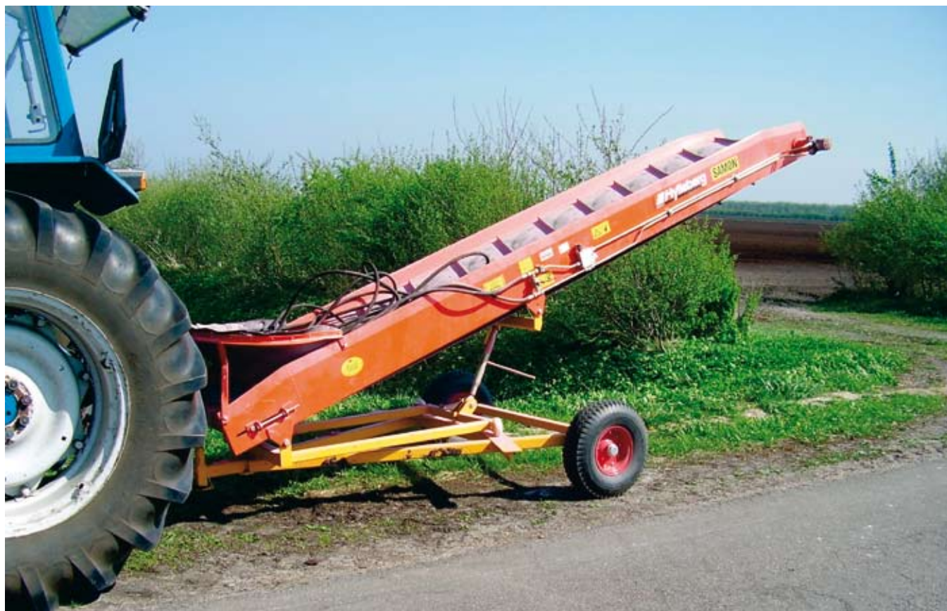
Figur 5. Transportør til sikker og skånsom fyldning af kartoffellæggeren.
